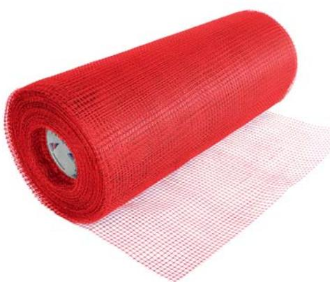
Кладочная сетка Porotherm JM укладывается в каждом ряду кладки из крупноформатных керамических блоков Porotherm с целью недопущения возможного проваливания кладочного раствора в большие пустоты, шириной более 10 мм.
