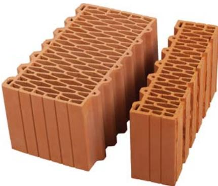
Крупноформатные керамические блоки Porotherm 44 предназначены для кладки наружных несущих стен в один ряд толщиной 440 мм без дополнительного утепления.
